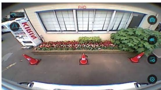
キャンピングトレーラーの運転でみなさんが一番苦手とするのがバック。弊社では専門メーカーに開発を依頼し駐車の際はもちろん、走行中でも後方視界を確認できるよう「Wi-Fi無線式バックカメラ」をご用意しております。これがあれば、視界となる後方の映像をスマホやタブレットで確認ができるようになります。面倒な配線の必要もなく、ヘッド車を取り替えても問題なく利用ができるのも特徴です。このバックカメラがあることで、移動もグンと楽になります。このカメラは「VIP Hybrid」に標準で装備されています。
